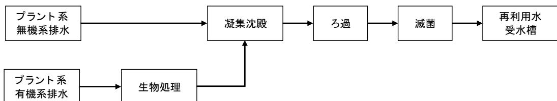
図 2-1 プラント系排水処理フロー（参考）
