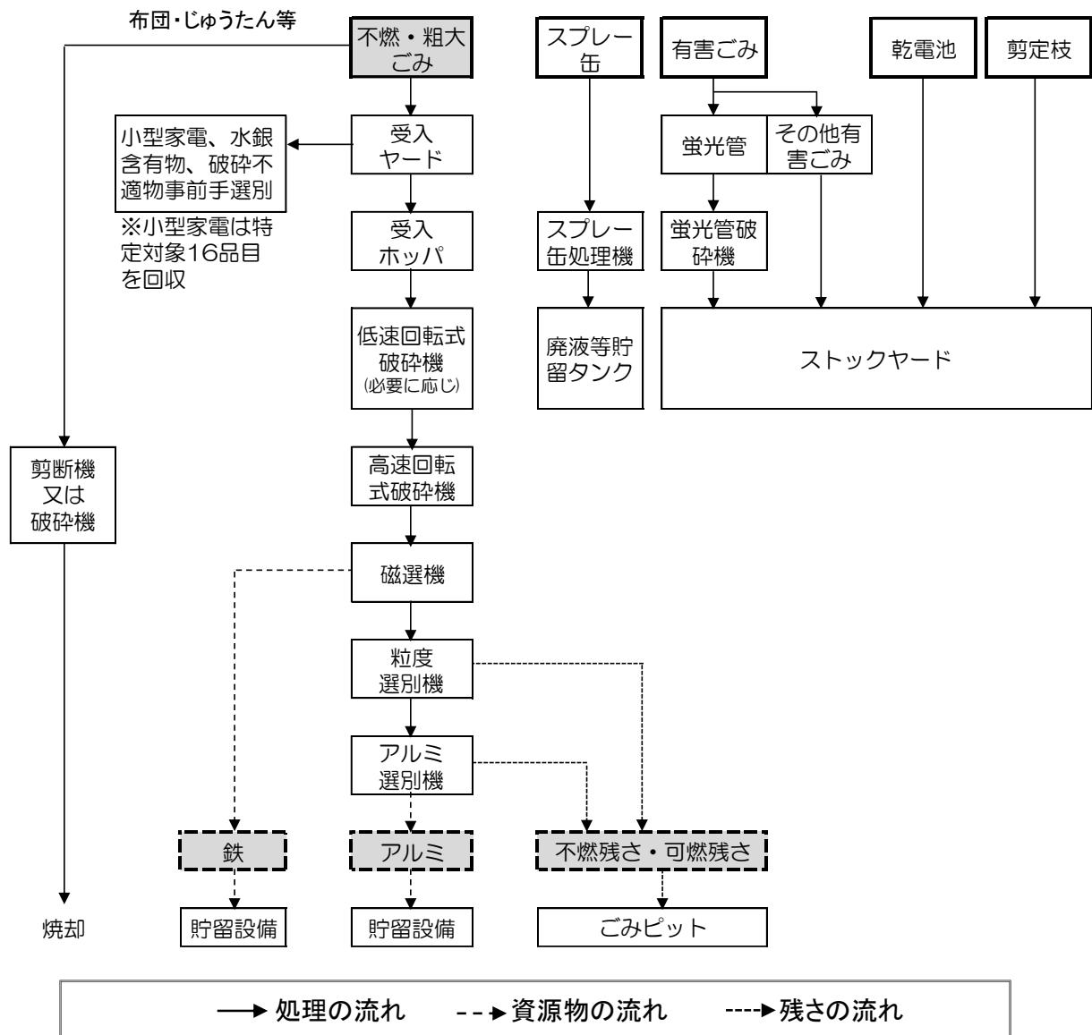
図 1-2 マテリアルリサイクル推進施設の基本処理フロー（参考）
