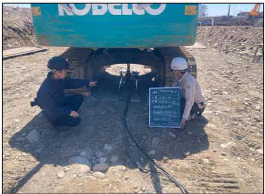
地耐力確認試験
